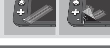
2 Richte die Schutzfolie vorsichtig an den Rändern des Touchscreens aus. Bringe die Schutzfolie dann langsam an und streiche sie mit einem Reinigungstuch glatt, um zu verhindern, dass sich zwischen Bildschirm und Schutzfolie Lufthäischen bilden. Entferne nun den Rest der Trägerfolie und bringe die andere Hälfte der Schutzfolie wie oben beschrieben an.
