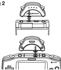
Um den Drahtlosen Adapter zu entfernen, vergewissere dich, dass dein Game Boy Advance-System ausgeschaltet ist (OFF). Drücke dann die Entriegelungshebel aufeinander zu und ziehe den Drahtlosen Adapter aus dem Game Boy Advance-System heraus (siehe Abbildung 3).
