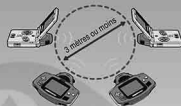
Game Boy Advance connectées avec les adaptateurs sans fil Game Boy Advance
